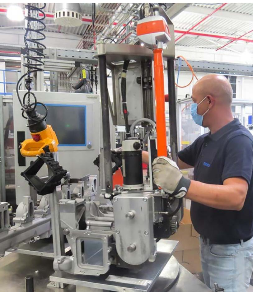
Erleichtertes Arbeiten bei MAHLE in Mühlacker: dank des neuen Lastenmanipulators
