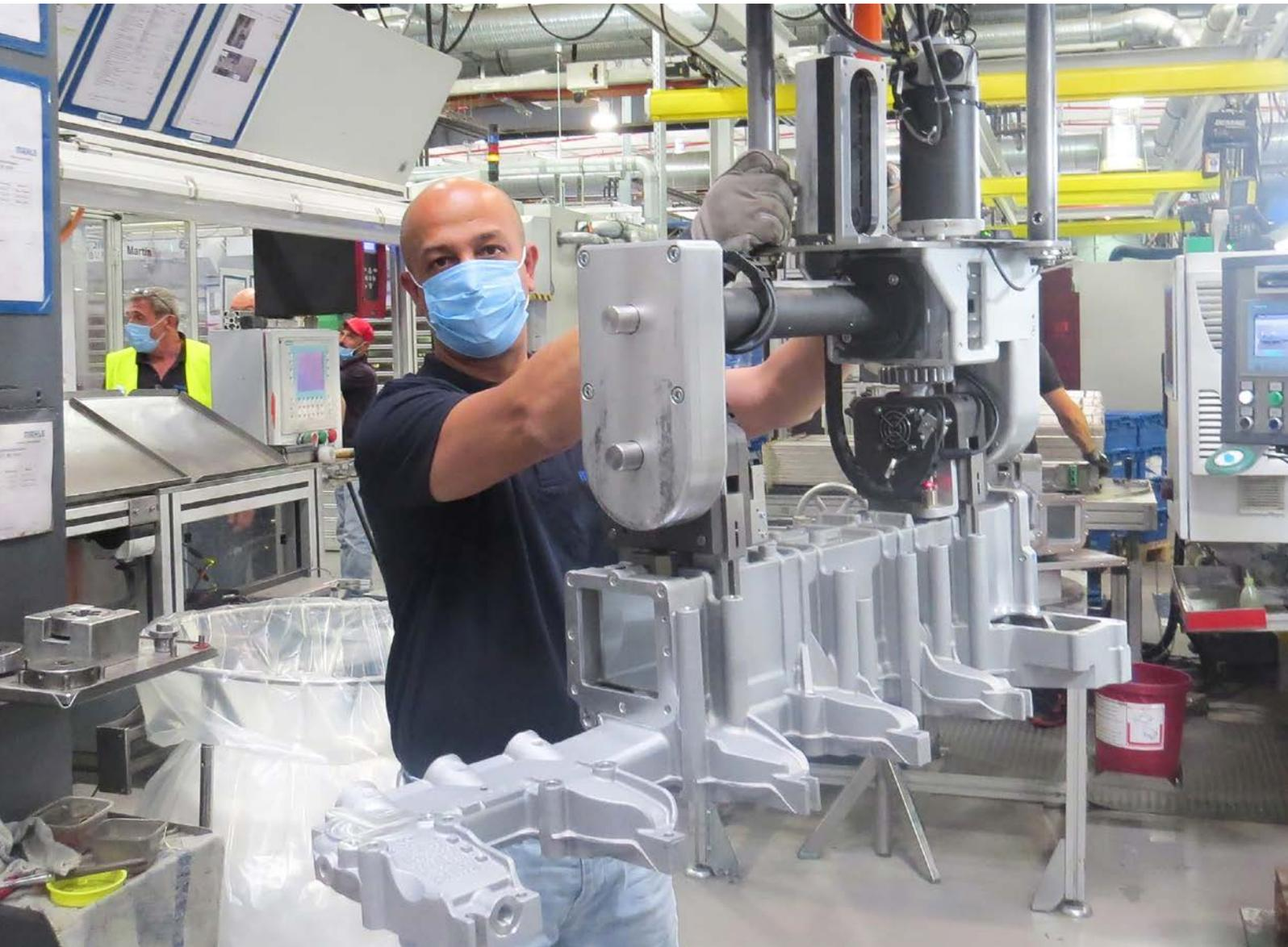
Mit dem Lastenmanipulator kann Produktionsmitarbeiter Elmi Zumberi die schweren Gussteile genau an die benötigte Position in der Fertigung bewegen.
