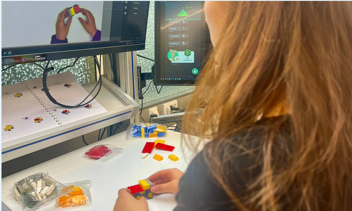
Die kamerakontrollierte Schritt-für-Schritt-Anleitung hilft beim Zusammensetzen des kompletten H-Autos.
